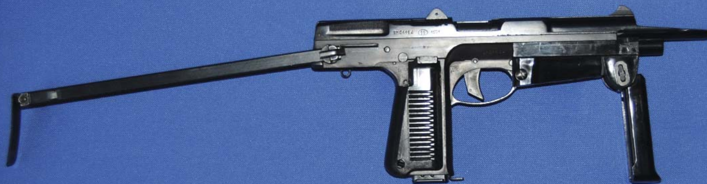
В боевом положении: приклад выдвинут, передняя рукоятка откинута вниз
